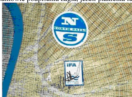
Rys. 20 Róg halsowy grota z etykietą żagla
