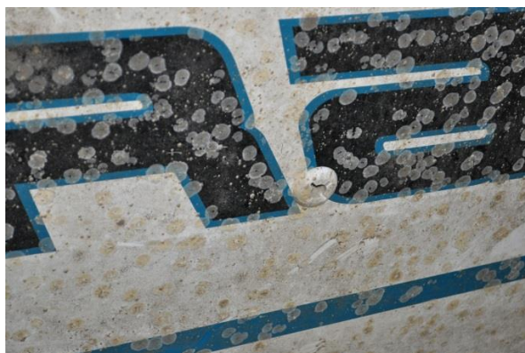
Zdjęcie nr 22. Burtowy wylot wody zenzowej
