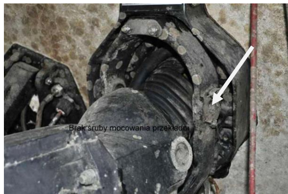
Zdjęcie nr 24. Brak śruby mocującej prawą przekładnię
