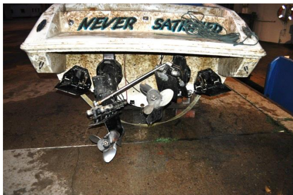
Zdjęcie nr 23. Uszkodzona przekładnia wahlowa jachtu
