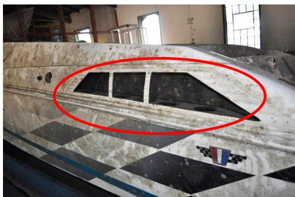
Zdjęcie nr 15. Czerpnia powietrza z lewej burty jachtu (po zdjęciu plastikowej osłony)
