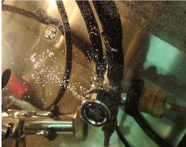
Zdjęcie nr 4. Nieszczelność na I stopniu regulatora głównego
