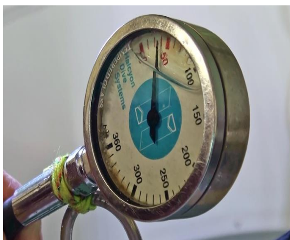
Zdjęcie nr 8. Manometr wskaźnikowy po próbie w symulatorze
