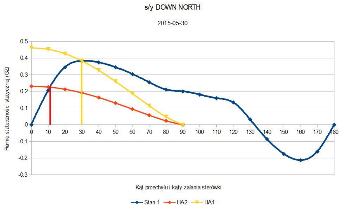
Rysunek 5. Krzywa ramion prostujących dla jachtu w stanie załadowania nr 1
