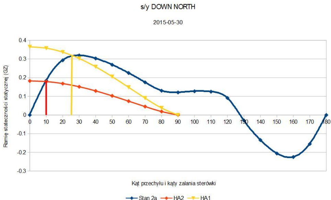
Rysunek 6. Krzywa ramion prostujących dla jachtu w stanie załadowania 2a
