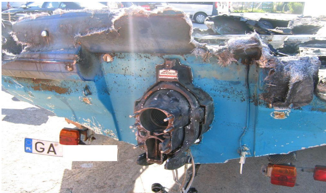
Zdjęcie nr 11. Pawęż jachtu z kardanowym zawieszeniem śruby napędowej
