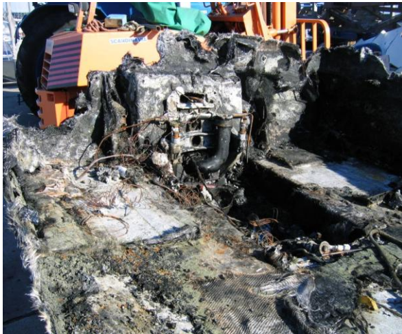
Zdjęcie nr 9. Druty sprężyn siedzeń, cięgna, przewody i elementy mocowania silnika
