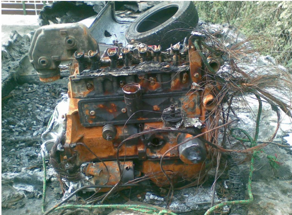
Zdjęcie nr 13. Korpus silnika zniszczony w wyniku pożaru i zalania wodą
