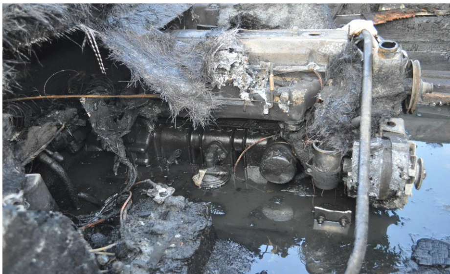
Zdjęcie nr 8. Korpus silnika zniszczony w wyniku pożaru i zalania wodą
