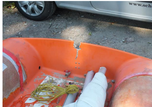
Zdjęcie nr 6. Brak górnego okucia zawiasu steru wraz z fragmentem pawęży, do której był przymocowany - widok od środka
