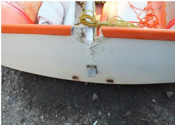
Zdjęcie nr 5. Brak górnego okucia zawiasu steru wraz z fragmentem pawęży, do której był przymocowany - widok z zewnątrz
