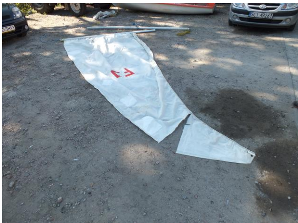
Zdjęcie nr 12. Uszkodzony fokżagiel
