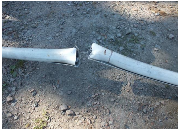
Zdjęcie nr 8. Złamany maszt
