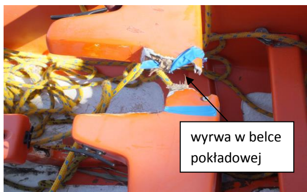
Zdjęcie nr 10. Uszkodzenie poprzecznej belki pokładowej
