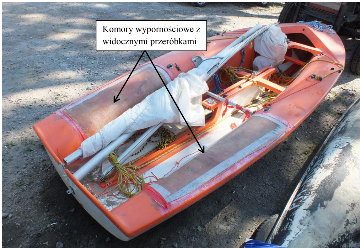
Zdjęcie nr 4. Widoczne przeróbki komór wypornościowych
