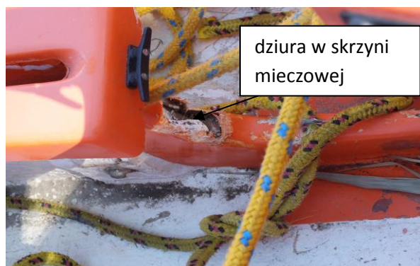
Zdjęcie nr 11. Uszkodzenie przedniej części skrzyni mieczowej
