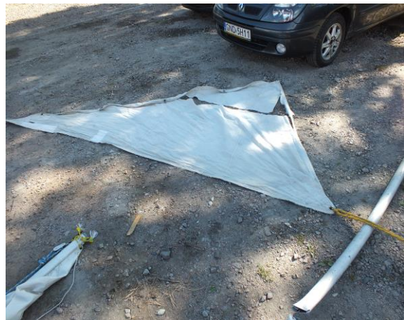
Zdjęcie nr 13. Uszkodzony grotżagiel
