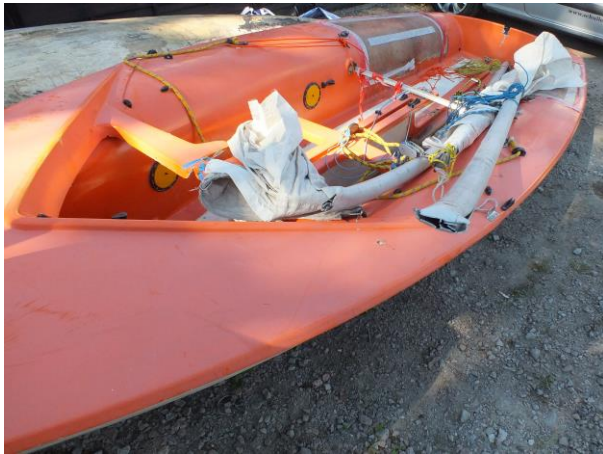
Zdjęcie nr 7. Złamany maszt
