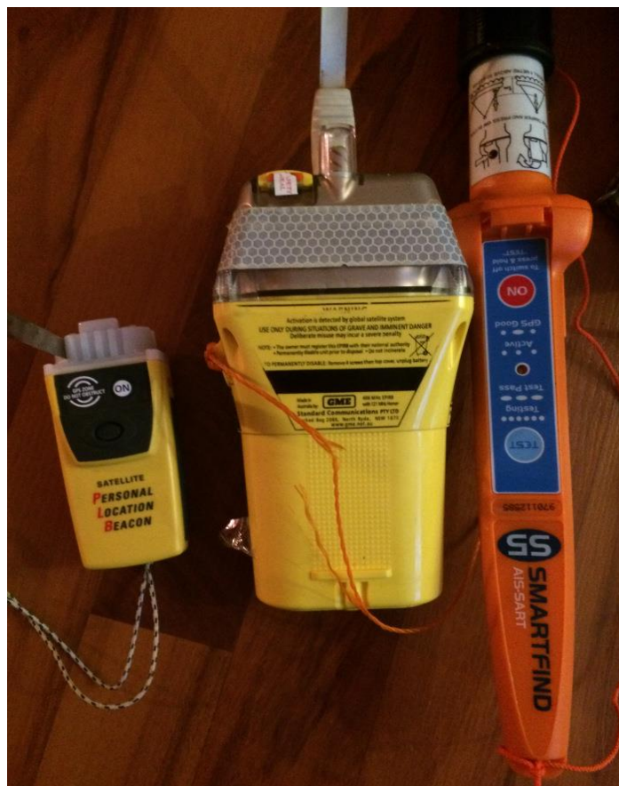
Zdjęcie nr 2. Środki alarmowania użyte w tratwie: EPIRB, PLB oraz AIS-Sart (źródło: kapitan).
