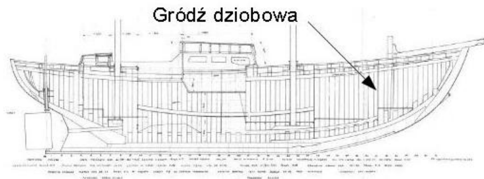
Załącznik nr 2. Złaz wzdłużny kadłuba według projektu przebudowy z 1981 r. Widoczna gródź dziobowa (źródło: CWM)
