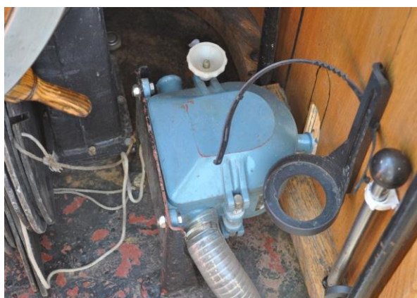
Zdjęcie nr 9. Jedna z dwóch ręcznych pomp pokładowych PPW 100
