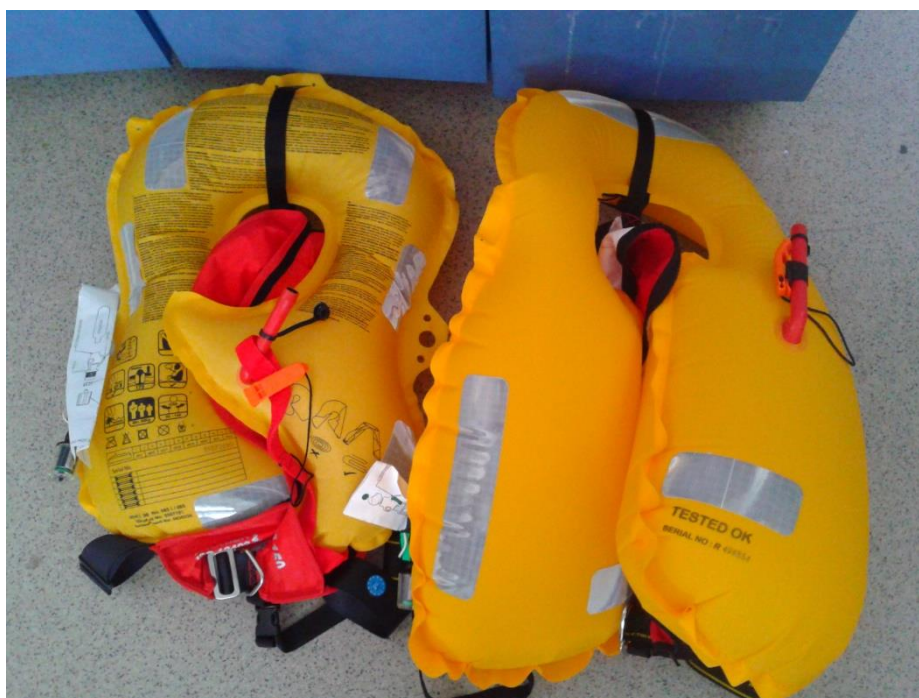
Zdjęcie nr 1. Napętnione gazem kamizelki pneumatyczne: po lewej 150 N, po prawej 275 N
